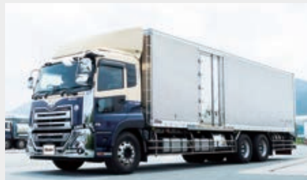
2024年10月に納車した、Quonの冷凍パン。外壁にはアルミコルゲートパネルを使用し高い断熱性能や、庫内にはジョロダレーを配したハイスベックな仕様を施している。必要かつ充分な機能を装備した即戦力の温度管理車として、ビジネスをサポート。輸送に大きな進化をもたらす。
